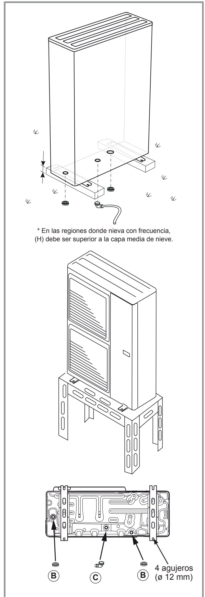
figura 13 - Colocación de la unidad exterior, evacuación de condensados
