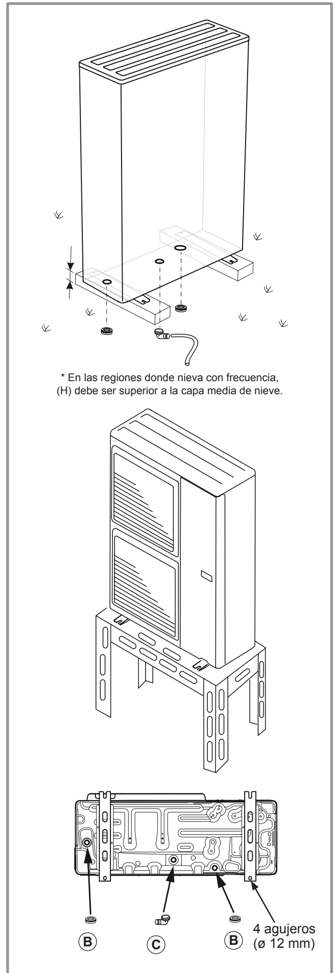
figura 14 - Colocación de la unidad exterior, evacuación de condensados
