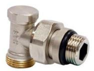
La función básica de los detentores es conectar o aislar el radiador. Ajustar el detentor es crucial para equilibrar la instalación y asegurar que la válvula del radiador trabaje con la autoridad adecuada. Se mejora el confort térmico y la eficiencia de las válvulas termostáticas. A continuación se muestra la gama de detentores Klimatech.
