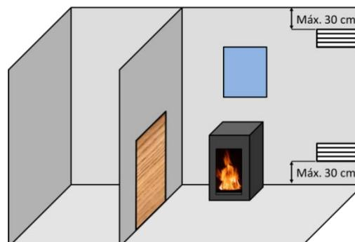
Figura nº2 - Esquema orientativo para rejillas de ventilación
