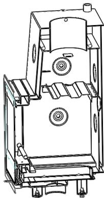
*Figura n°16 - Vista de sección con un deflector colocado (Otazu)*
