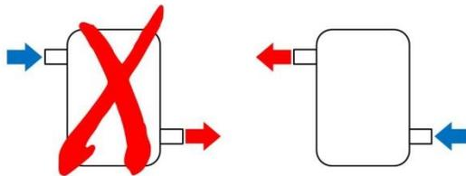
Figura n°10 - Conexión incorrecta (izda.) y conexión correcta (dcha.)
