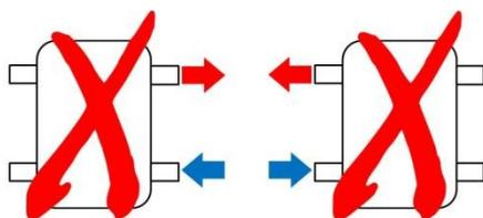
Figura n°11 - Conexiones incorrectas (menor potencia térmica al agua)
