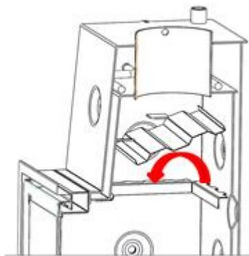
*Figura n°18 - Desmontaje del deflector superior Otazu Plus*
