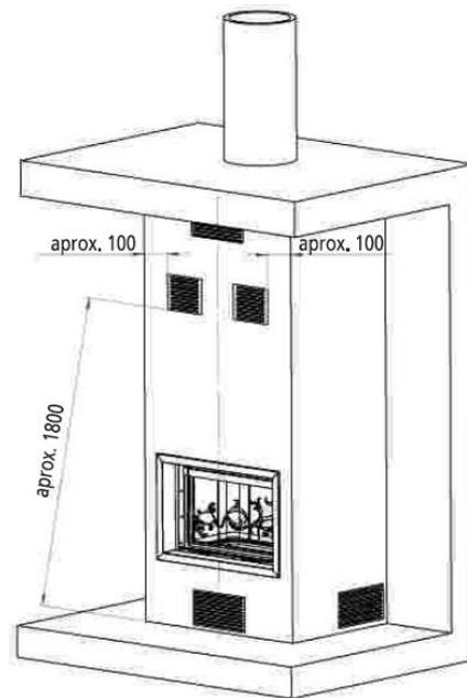
Figura n°4 - Esquema exterior del cerramiento
