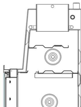
*Figura n°19 - Vista de sección con dos deflectores colocados (Otazu Plus)*
