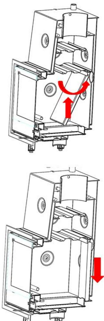
*Figura n°20 - Meter la pieza girando y empujando hacia arriba hasta liberar la pestaña inferior y dejar caer*
