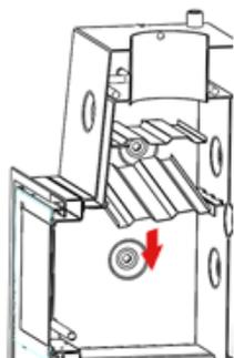
*Figura n°17 - Desmontaje del deflector inferior Otazu Plus*
