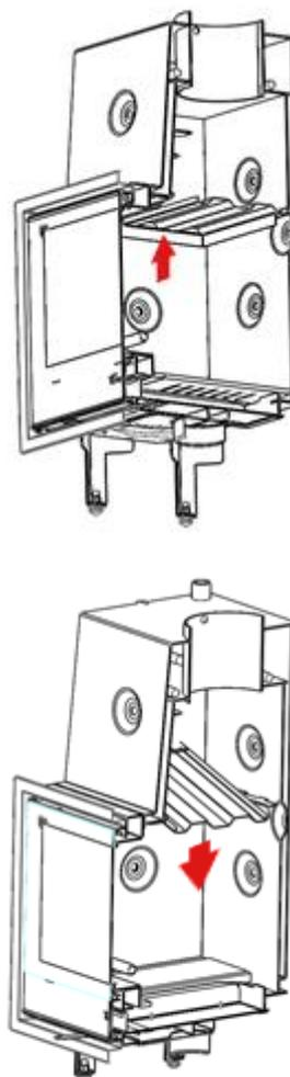
Figura n°15 - Desmontaje del deflector OTAZU
