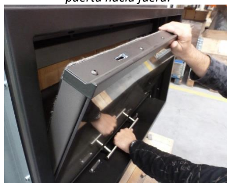
Figura nº37 - Sujetamos la puerta firmemente con ambas manos mientras la abatimos
