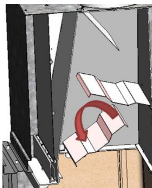
Figura nº28 - Desmontaje del deflector medio Itaca 80
