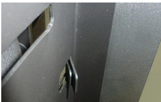
Figura nº13 - Detalle de pestaña doblada
