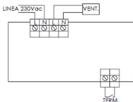
Figura nº27 - Conexiones a realizar en el potenciómetro.
