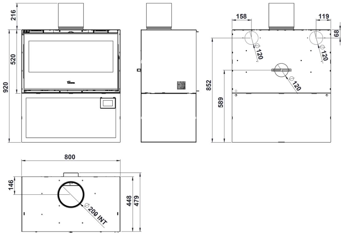
Figura nº5 - Dimensiones en mm del aparato ROCK 800 Plus
