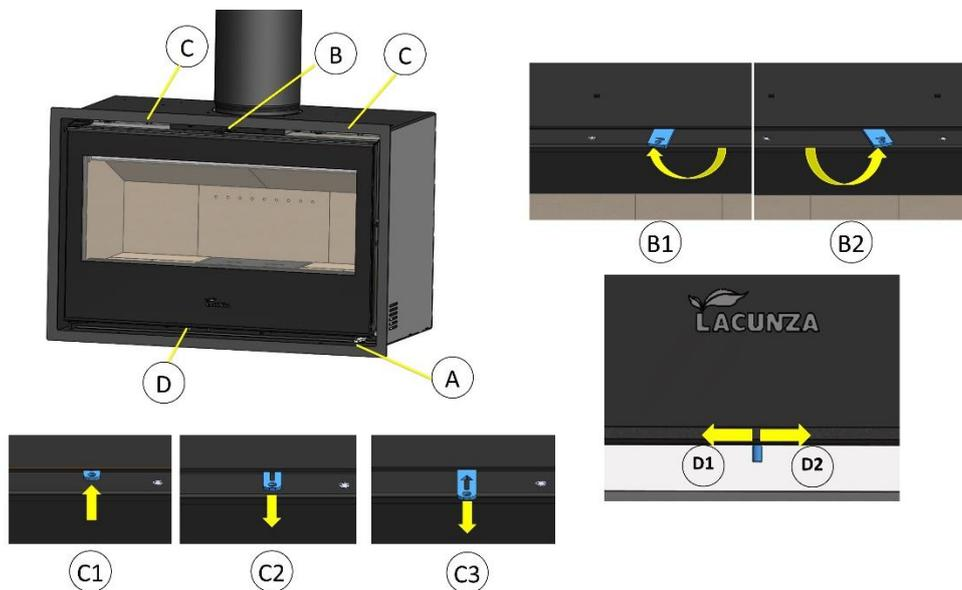
Figura n°32 - Elementos de funcionamiento del aparato
