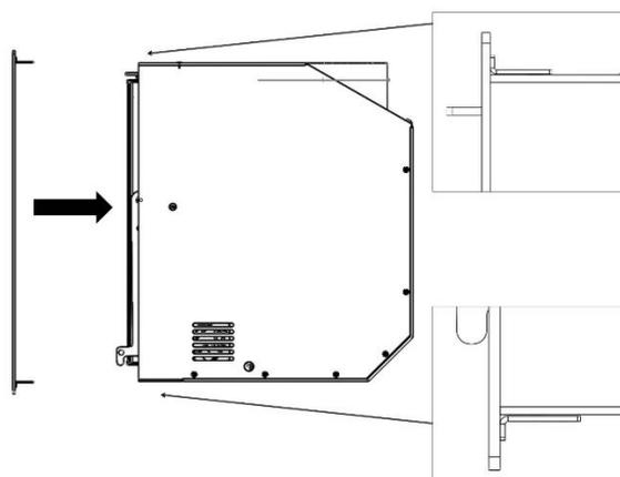
Figura n°26 - Meter marco por el exterior
