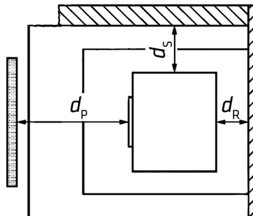
Si el aparato es una chimenea insertable, las distancias se miden desde la cara exterior del cerramiento ignífugo.
