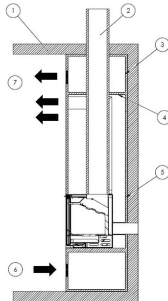
Figura nº8 - Esquema interior del cerramiento
