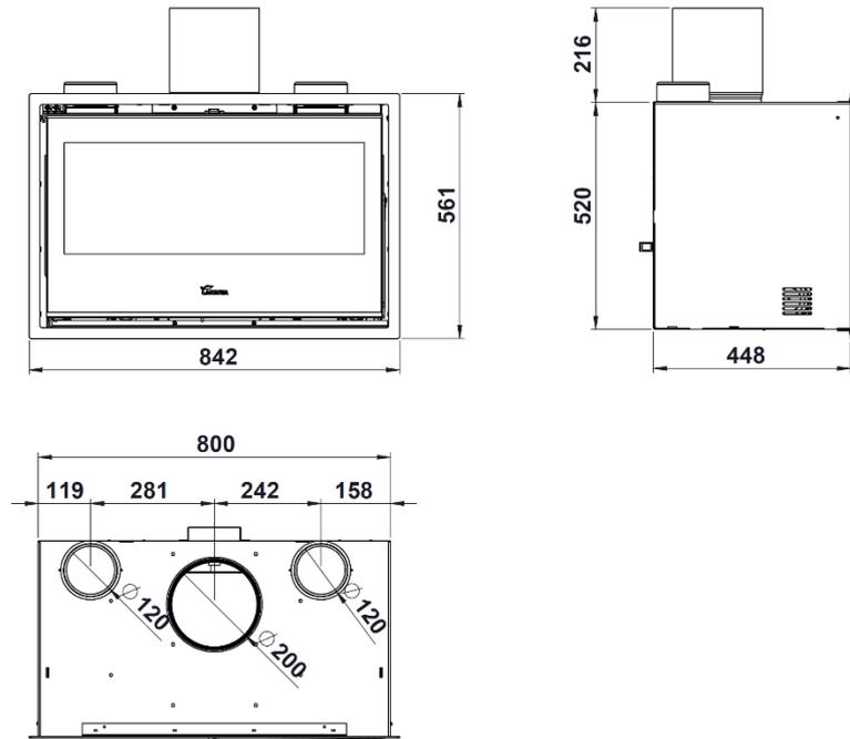
*Figura n°2 - Dimensiones en mm del aparato GOLD 800 Plus*
