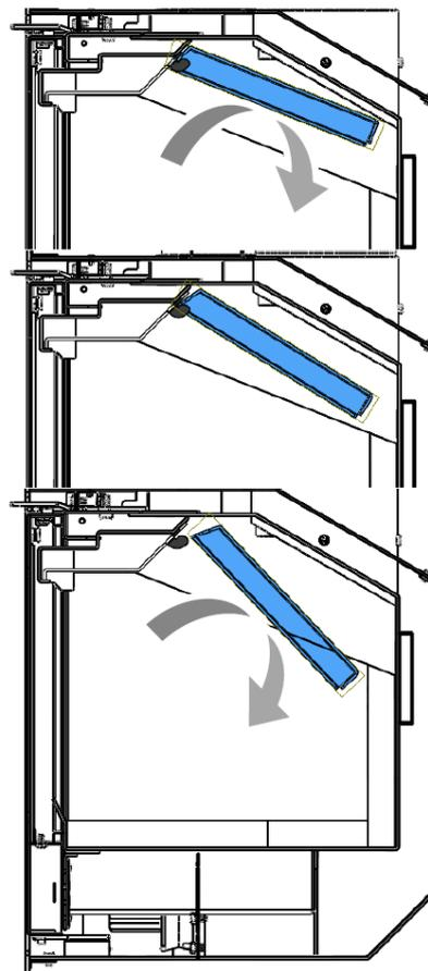
Figura nº36 - Girar y extraer el deflector superior de Acero
