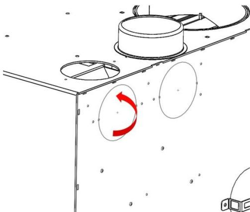
Figura n°12 - Abrir salida de aire trasera GOLD.
