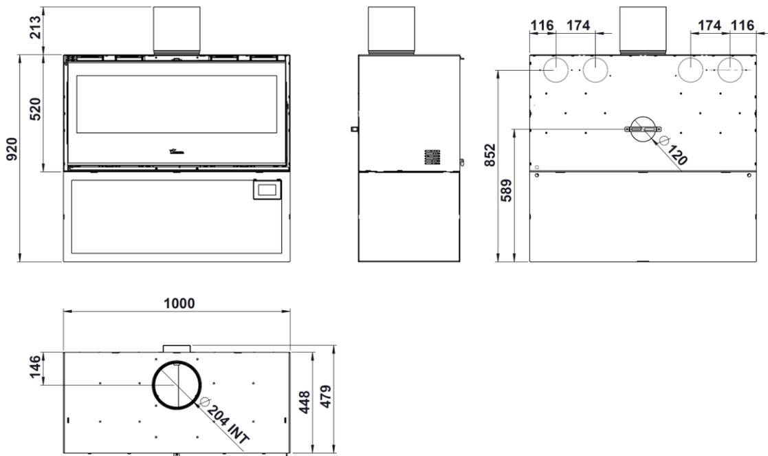
Figura n°6 - Dimensiones en mm del aparato ROCK 1000 Plus
