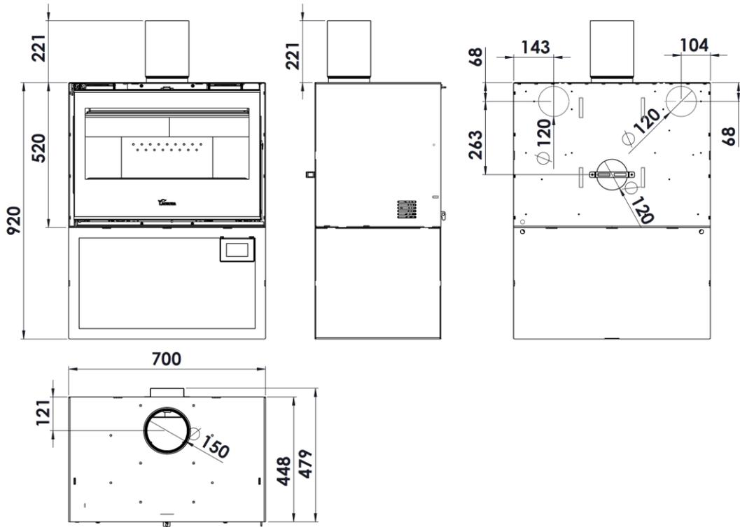
Figura nº4 - Dimensiones en mm del aparato ROCK 700 Plus
