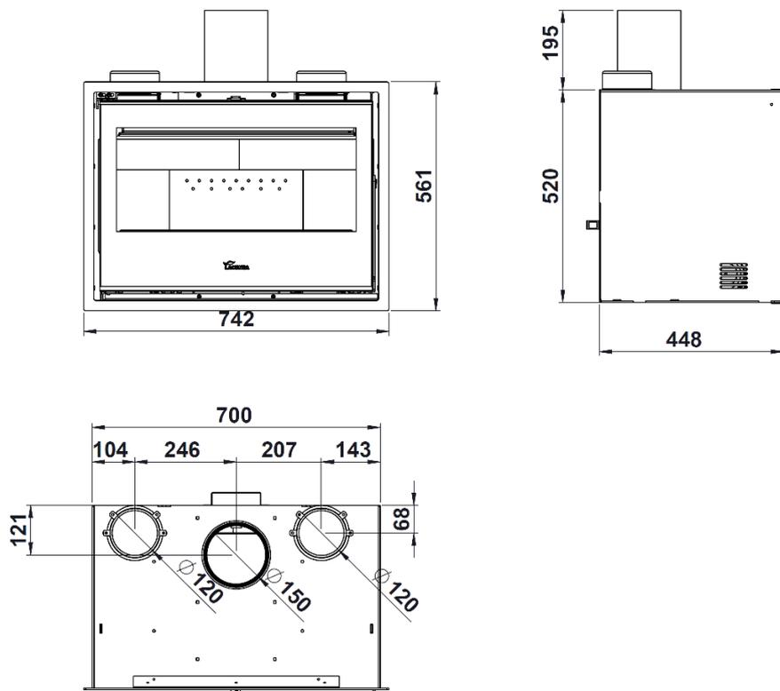
Figura n<sup>o</sup>1 - Dimensiones en mm del aparato GOLD 700 Plus
