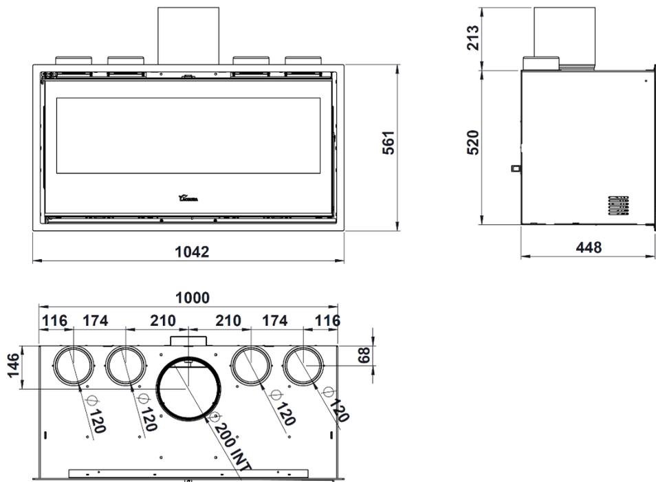
*Figura n°3 - Dimensiones en mm del aparato GOLD 1000 Plus*
