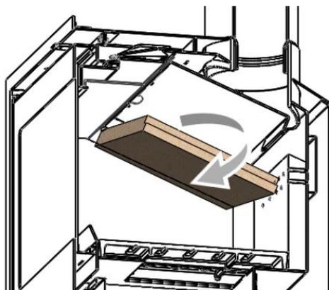
Figura nº35 - Extracción de los deflectores de vermiculita
