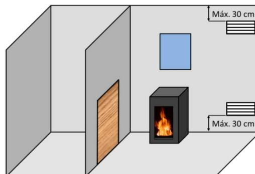
Figura nº7 - Esquema orientativo para rejillas de ventilación
